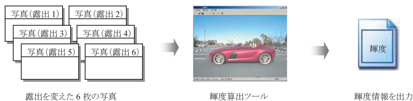
図3 輝度算出ツールによる輝度算出の流れ
