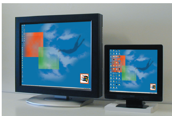
図 1 8008 高解像度 LCD (左側) と 17 型 LCD (右側) の画像サイズ比較 (画面はハメコミ合成)
