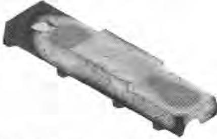
図 20 冷却解析温度分布 上面鳥瞰図 (冷却管 4 本)
