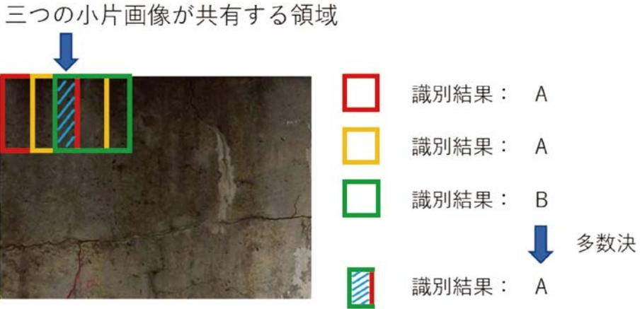
図7 各ピクセルの識別結果
