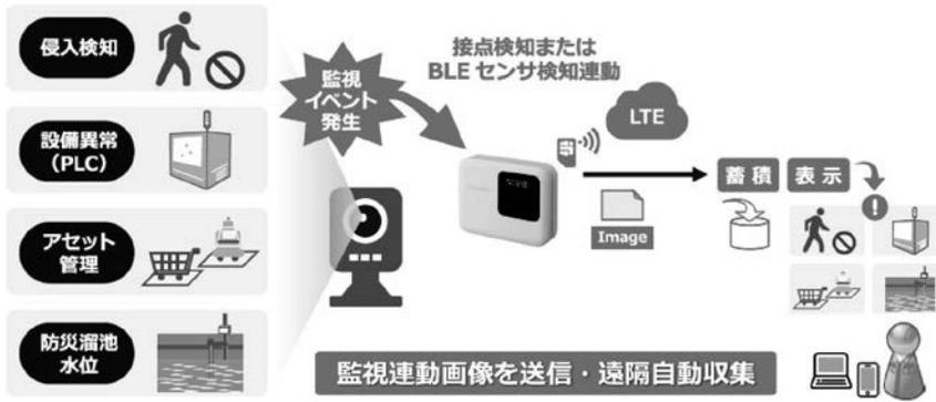
図7 センサ検知イベントと連動したカメラ構成
