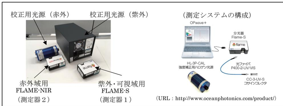
図11 計測装置外観と構成イメージ
