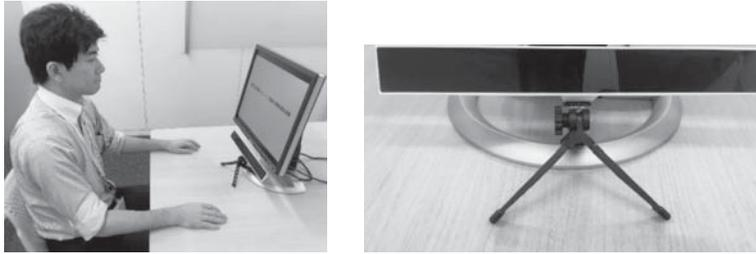
図1 実験の様子（モニタ下部にイトラッカを設置して視線を計測）
