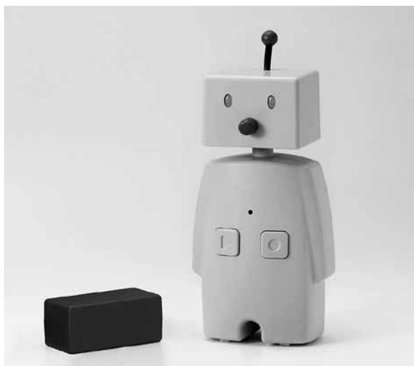
図1 BOCCO（右）と付属の振動センサ（左）
