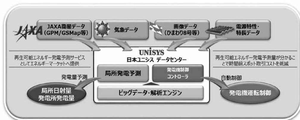
図7 再生可能エネルギー発電量予測サービス概要図
