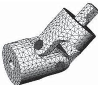
図4 有限要素法による機械部品の離散化モデル
