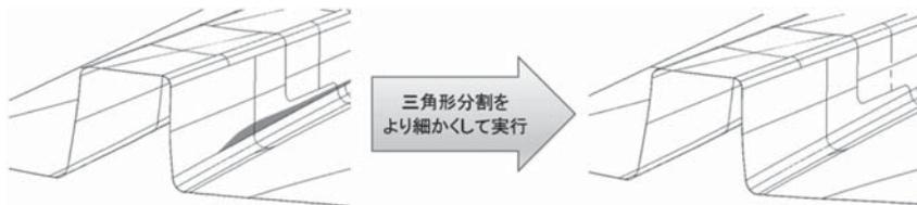
図 13 データ  $\beta$  で三角形分割を細かくして実行した結果
