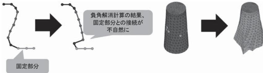
図 14 固定拘束により不自然な形状になる例と対称形状の負角解消ケースの例
