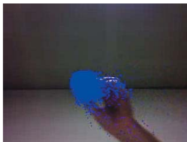
図4 パーティクルフィルターを用いた対象物体のトラッキング
