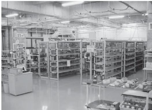
図5 通電・機能検査 (通電ラックに入った移動棚)
