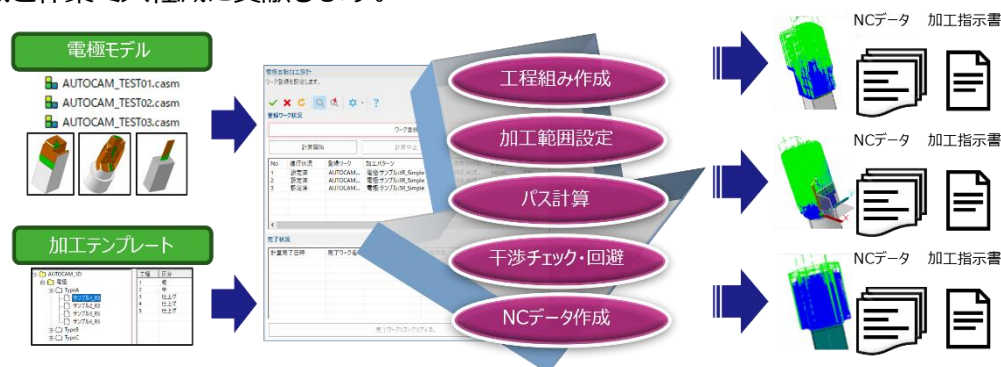
図 2 電極加工データ作成自動化
