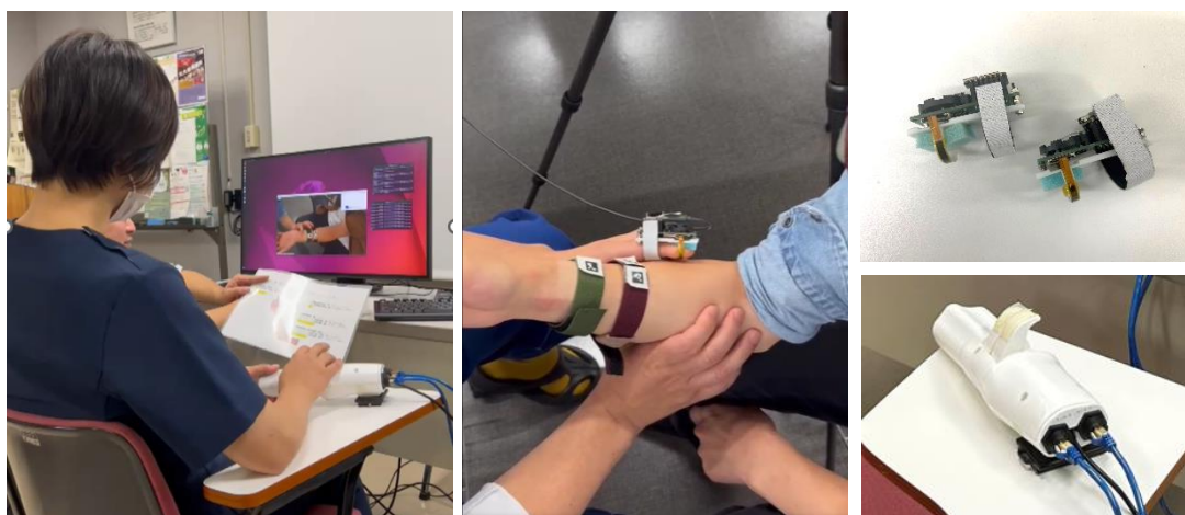
図3 札幌、帯広、函館3拠点遠隔触診実験 (左:受信側、中央:送信側、右上:センサーデバイス、右下:触覚再現器)
